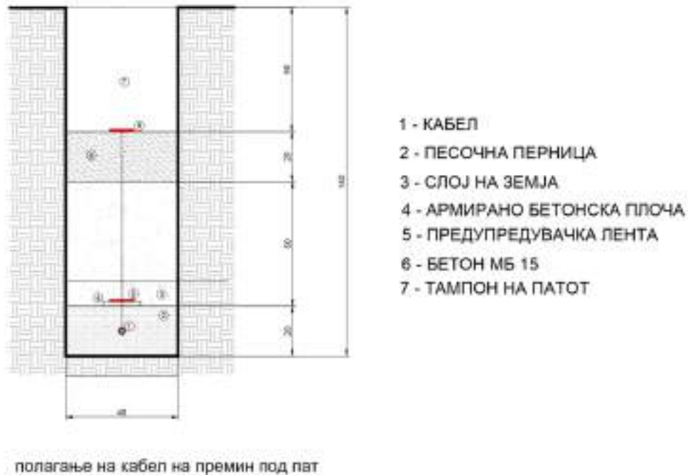
Слика 3 Полагање на кабел на премин под пат
